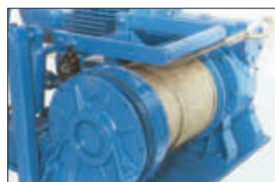
Slappe kabel beveiliging Slack wire switch
