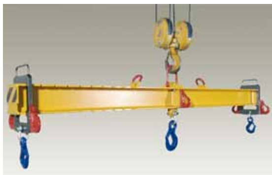
Kwint hijsjuk, verstelbaar, inclusief hijsplaten Verstelbereik = 1/2 werklengte
