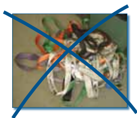
Verkeerde opslag van stropen.
