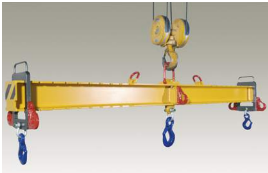
Kwint hijsjuk, verstelbaar, inclusief hijsplaten Verstelbereik = 1/2 werk lengte
