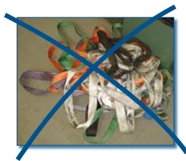
Verkeerde opslag van stropen.
